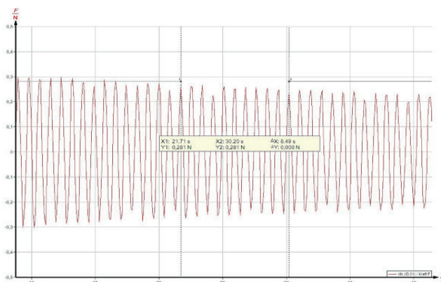
Рисунок 3. Определение частоты f за период времени T на расстоянии между колебательными максимумами. Для большей точности здесь в среднем 10 максимумов. \Delta x представляет собой разницу между двумя выбранными максимумами.
